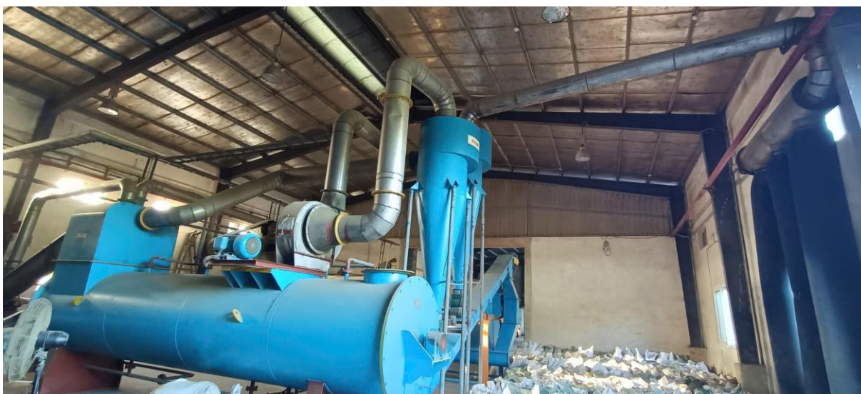
Hệ thống thu gom, xử lý bụi trong quá trình nghiền, sàng
